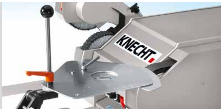
Заточка на влажной абразивной ленте
