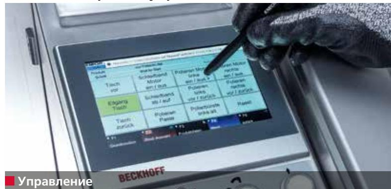
Станок B 500 исключительно прост в управлении. Наиболее важные функции, такие, например, как количество циклов заточки и полирования, а также выпуклость ножей оператор определяет непосредственно на сенсорной панели станка. Таким образом, после каждой последующей заточки профиль режущего инструмента ножа точно соответствует продукту, для которого он предназначен.
