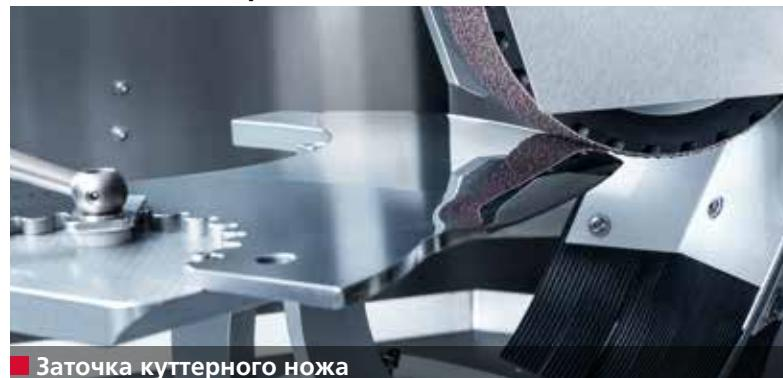
Острота, угол режущей кромки, форма и профиль куттерного ножа имеют большое влияние на качество производимой продукции.
